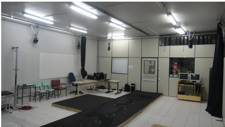
Imagem do laboratório composto por um sistema para análise cinemática operando com 9 câmeras infravermelhas e 4 plataformas de força.
